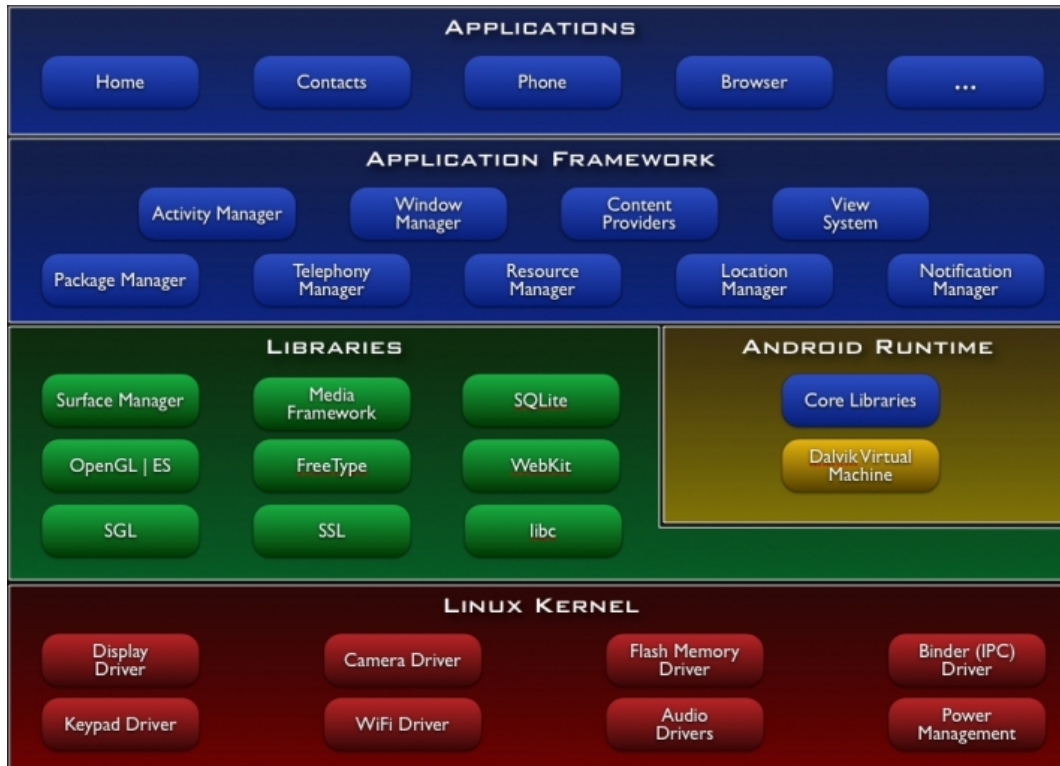
Figura 1: Camadas da plataforma Android - ( http://www.devmedia.com.br/android-a-nova-plataforma-movel-parte-ii/8432 )
