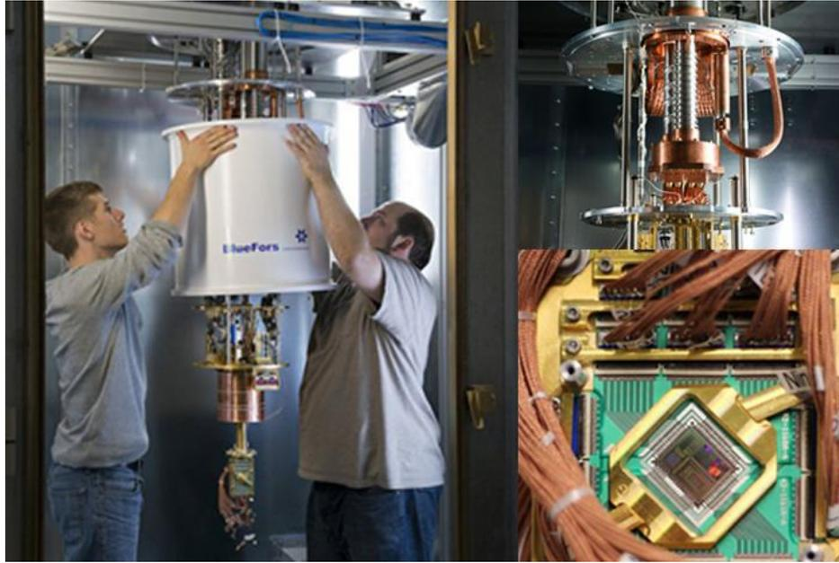
Fig.7: Sistema de Blindagem e Refrigeração<sup>4</sup>
