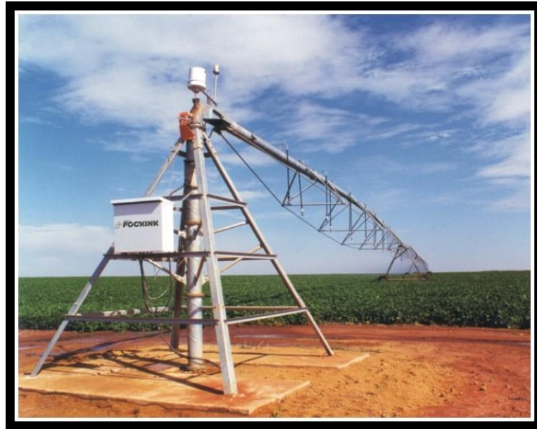
Figura 9 - irrigação por pivô central (PROTERRA, 2013)
