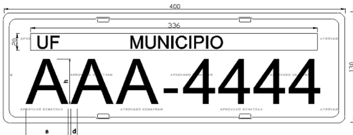
Figura 1: Dimensões para placas de veículos. Fonte (CONTRAN, 2007).
