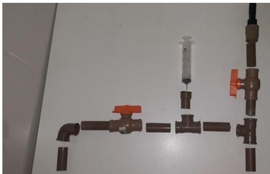
**Figura 10: Esquema de montagem do equipamento**
