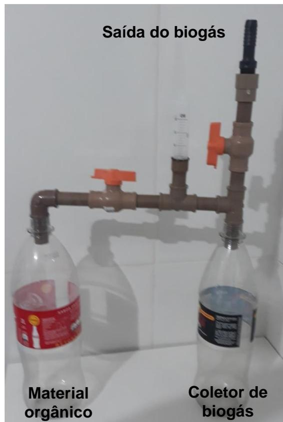
**Figura 12:** Esquema do equipamento ligado às garrafas, que receberá o material orgânico e a garrafa coletora de gás.
