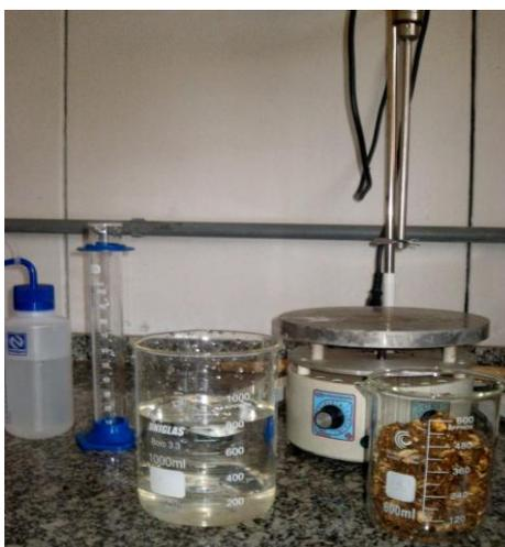
**Figura 11 – Proporção de Raiz x Solvente para Extração da Inulina.**
