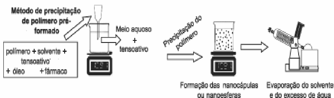
Figura 17- Representação esquemática do método empregado na preparação de nanocápsulas baseado na precipitação do polímero pré-formado (In: SCHAFFAZICK et al., 2003)
