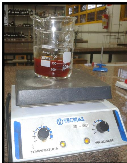
**Figura 15 – Extração do pigmento com agitador e aquecimento.**
