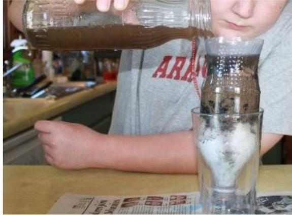
**Figura 8 – Filtro de água montado com garrafa PET (In: ATITUDES SUSTENTÁVEIS, 2014).**
