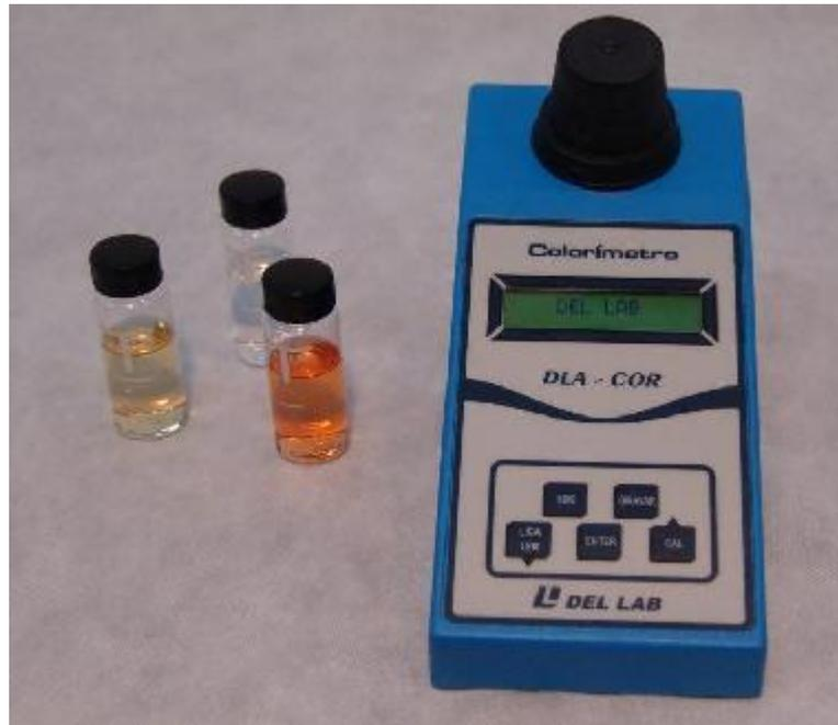
**Figura 5 – Aparelho Colorímetro (In: METROLÓGICA, 2014).**
