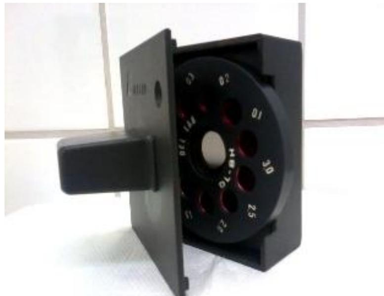
**Figura 13 - Disco de cores acoplado ao aparelho colorímetro**
