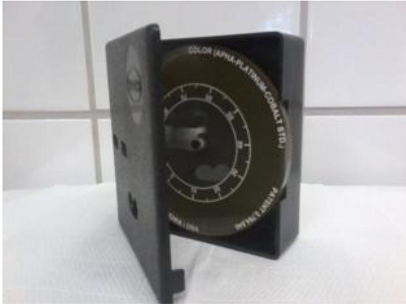
**Figura 6 - Disco de cores acoplado ao aparelho colorímetro**
