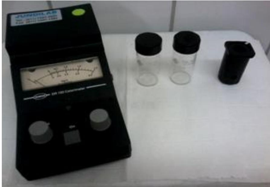
**Figura 15 - Aparelho fluorímetro, cubetas e adaptador**
