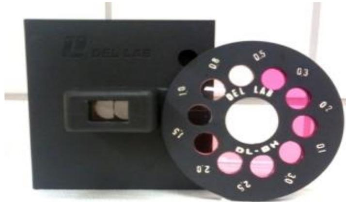
**Figura 12 - Aparelho colorímetro e disco de cores**
