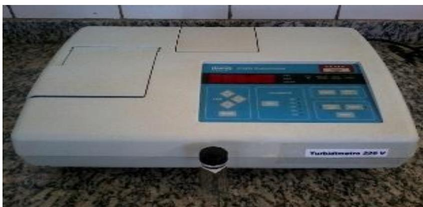
**Figura 8 - Aparelho turbidímetro e cubeta**
