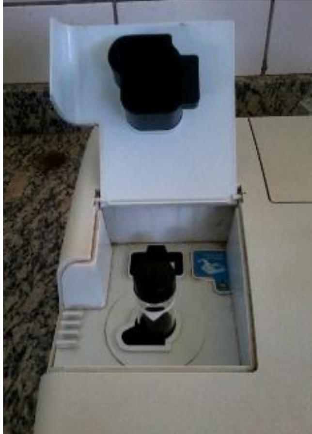
**Figura 9 - Cubeta dentro do aparelho turbidímetro**
