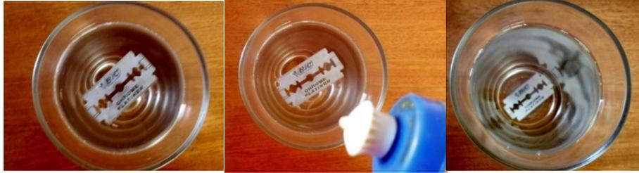
**Figura 11 – Experimento de tensão superficial.**
