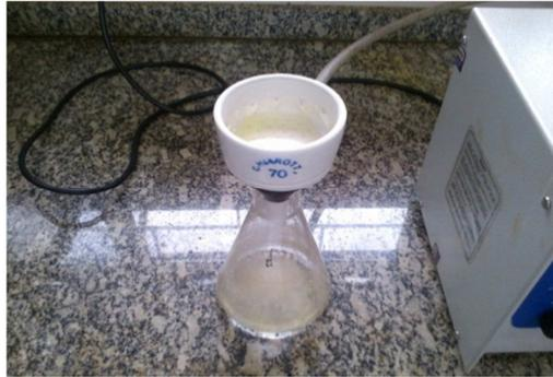
**Figura 13 – Filtração a Vácuo**
