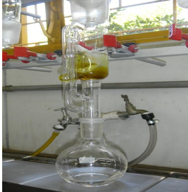
Figura 6: Processo extração do sohxlet
