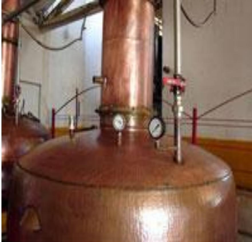
**Figura 4 Destilador de cobre utilizado na produção de cachaça artesanal.**
