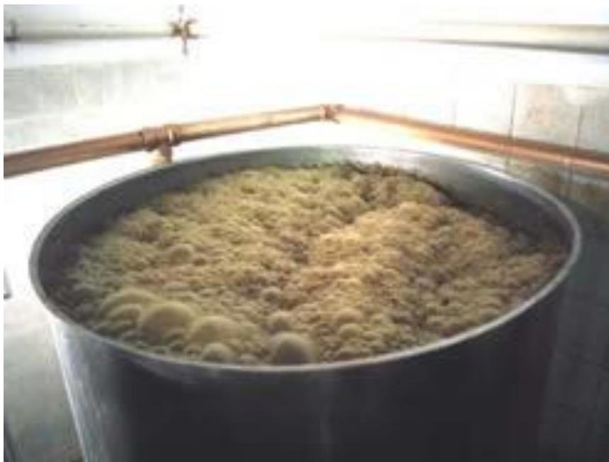
**Figura 3- Modelo de dorna de fermentação construída em aço inoxidável. Fonte (OLIVEIRA, 2010)**
