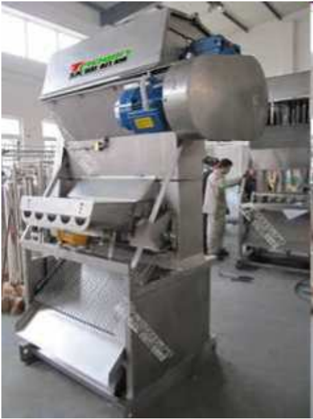
Figura 9. Método de destilação por prensagem (SHIEDECK, 2011, p. 37).
