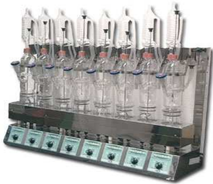
Figura 8. Aparelho de Soxhlet para extração de óleo essencial com solvente (SHIEDECK, 2011, p. 36).
