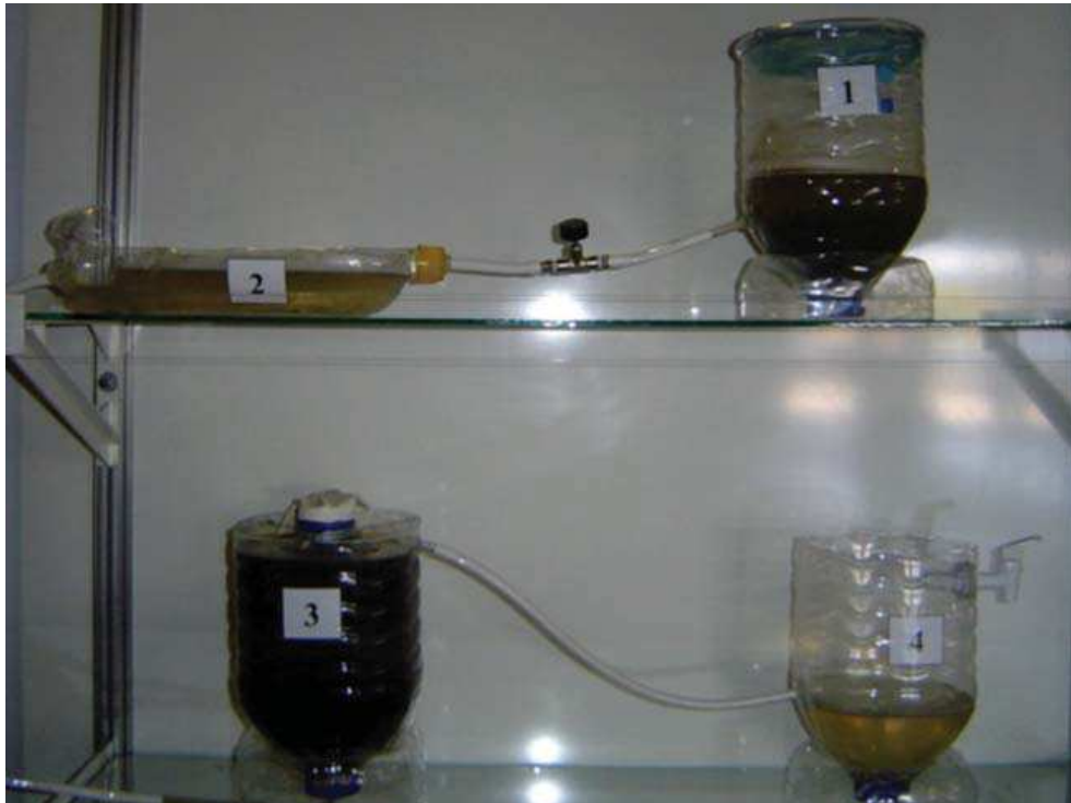
Figura 13 – Protótipo de ETE de reator anaeróbico (KONDO; ROSA, 2007).
