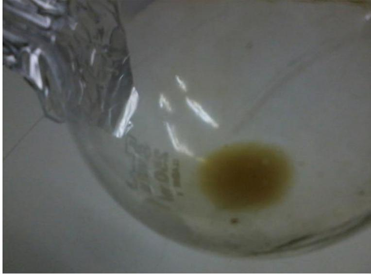
**Figura 8 – Gel obtido após processo de rotaevaporação**
