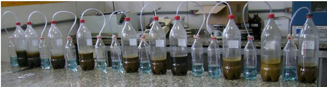
**Figura 27 – Biodigestores, acoplados em garrafas submersas em água**
