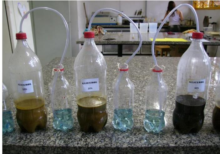
**Figura 20 - Biodigestores em garrafas acopladas com água na presença do indicador verde de bromocresol**
