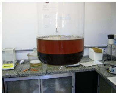
Figura 12 – Diferenças de Fases do Biodiesel e Glicerol.
