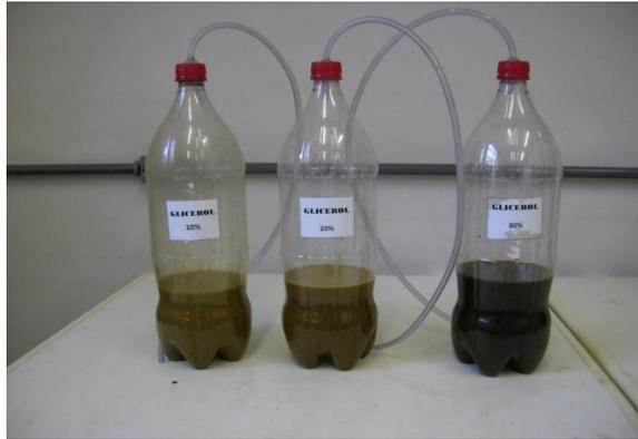
**Figura 23 – Biodigestores, com adição de glicerol, nas proporções 10%, 20% e 30%**
