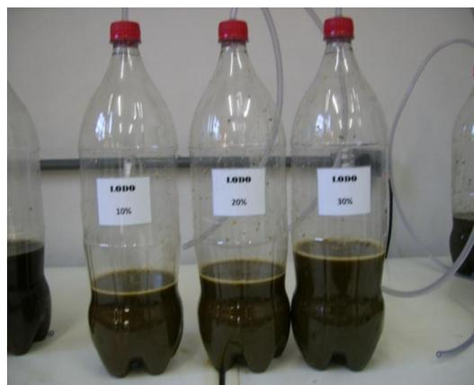
**Figura 25 – Biodigestores, com adição de lodo, nas proporções 10%, 20% e 30%.**
