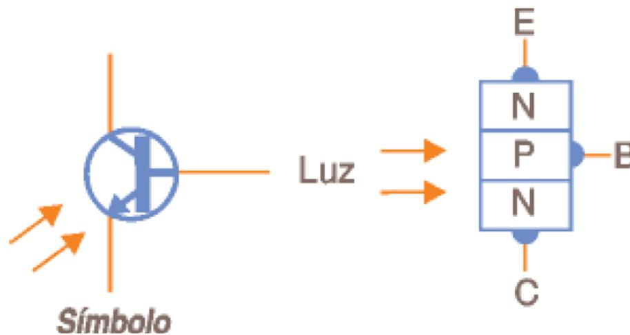
**Figura 3 – Representação Foto Acoplador**
