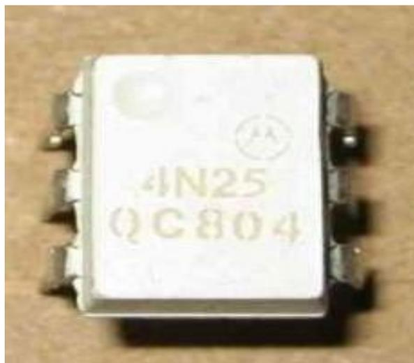
**Figura 4 - Foto Acoplador 4N25**
