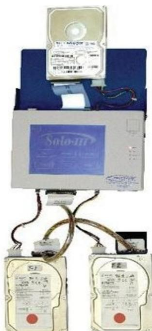
Figura 1 – Solo III, com HDs conectados
