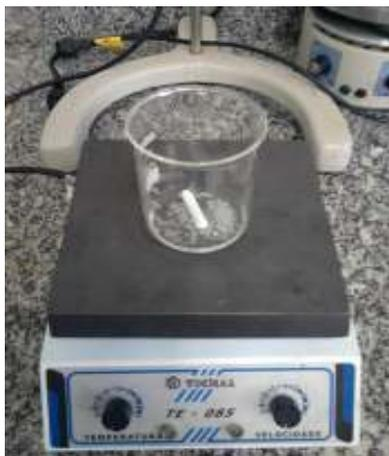
**Figura 19 – Processo de lavagem do PET sob agitação.**
