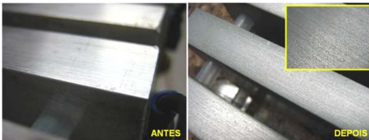
Figura 40 – Eletrodos de consumo, antes e depois da eletrólise.
