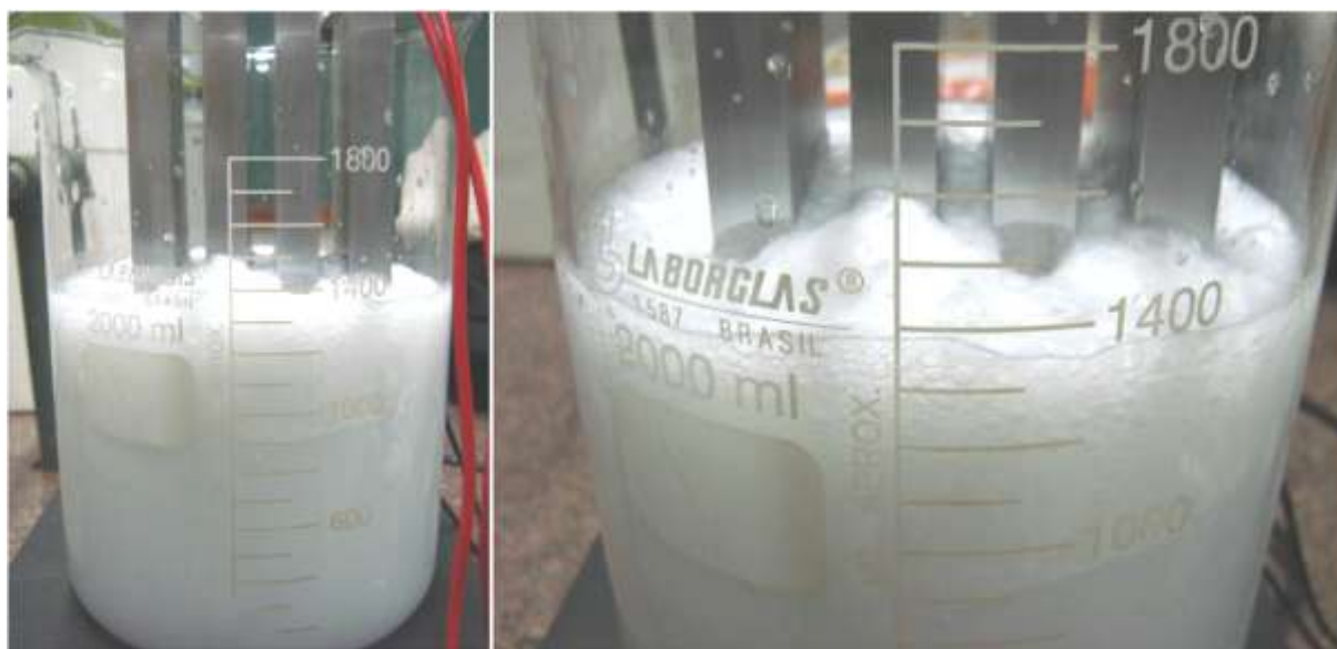
Figura 38 – Aspecto do efluente durante o tratamento eletrolítico.
