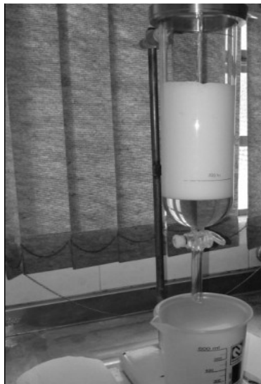
Figura 18. Foto da análise de espuma da cerveja pelo método sigma (In: Acervo pessoal).
