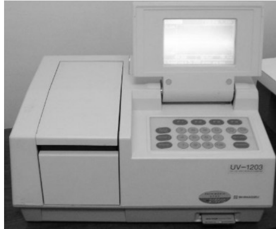
Figura 14. Espectrofotômetro UV-vis Shimadzu modelo UV-1203. (In: https://repositorio.ufsc.br )
