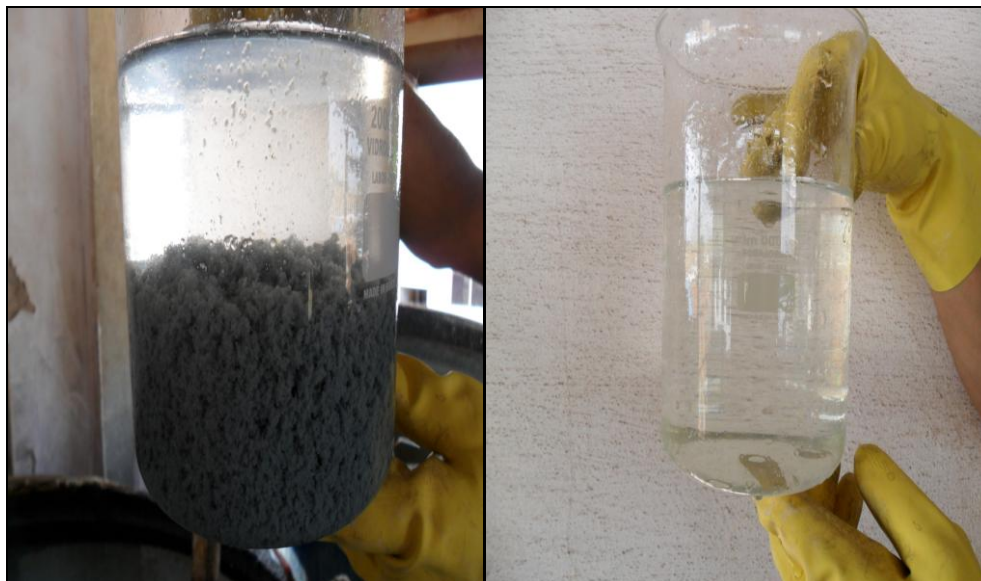
Figura 11 - Tratamento com polieletrólito.
