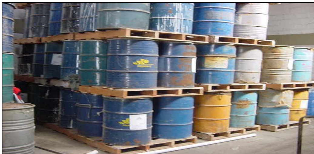
Figura 12 - Forma adequada de acondicionamento e estocagem de resíduos perigosos (In. SIMAS, 2007, p.68).
