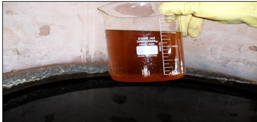
Figura 8 – O cromo com coloração marrom ocre indicando cromo hexavalente.
