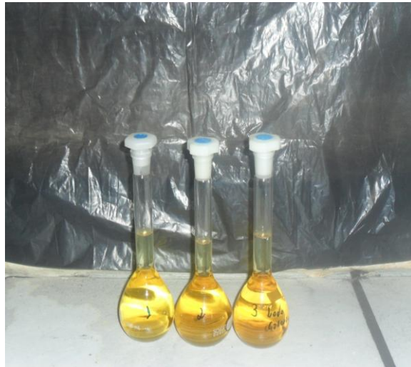
Figura 6 – Amostras digeridas através de digestão nitroperclórica do lodo caleado
