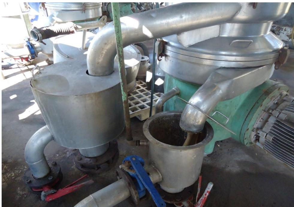
**Figura 7 – Centrifuga de fermento - Levedo centrifugado**
