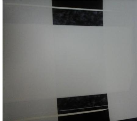
Figura 41: Espessante A – PVC 30 – 105 KU    Figura 42: Espessamento B – PVC 30 – 105 KU
