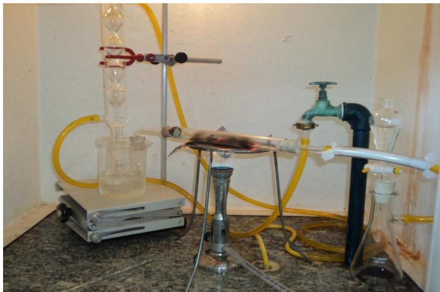
**Figura 19 – Esquema para obtenção do SiCl<sub>4</sub>**
