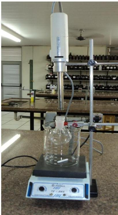
**Figura 23– Esquema para produção das partículas e nanopartículas de sílica**
