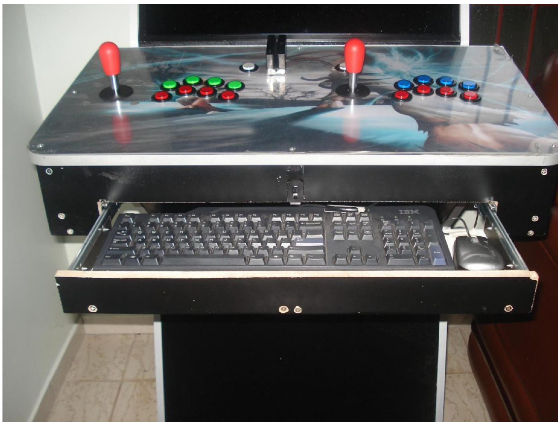
Figura 78 – Leitor fixado no Controle e gaveta para teclado e mouse
