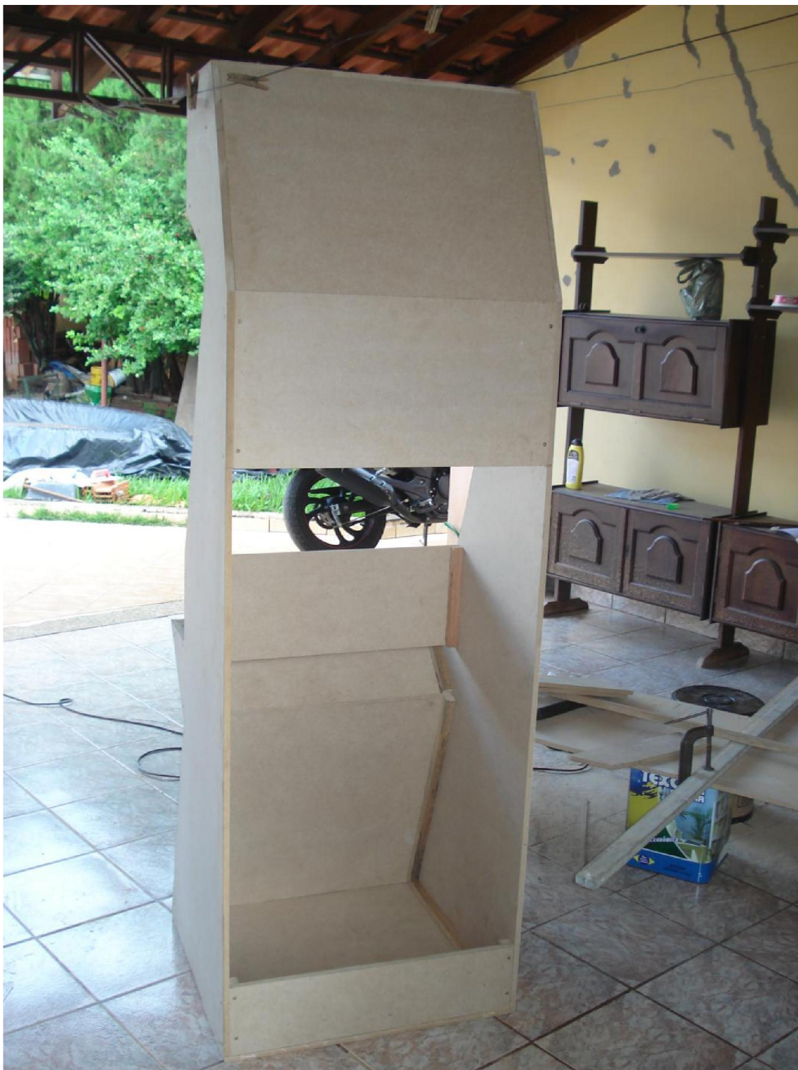
Figura 58 – Partes superior traseiras e parte anterior do controle, presas as laterais por meio de sarrafos e parafusos
