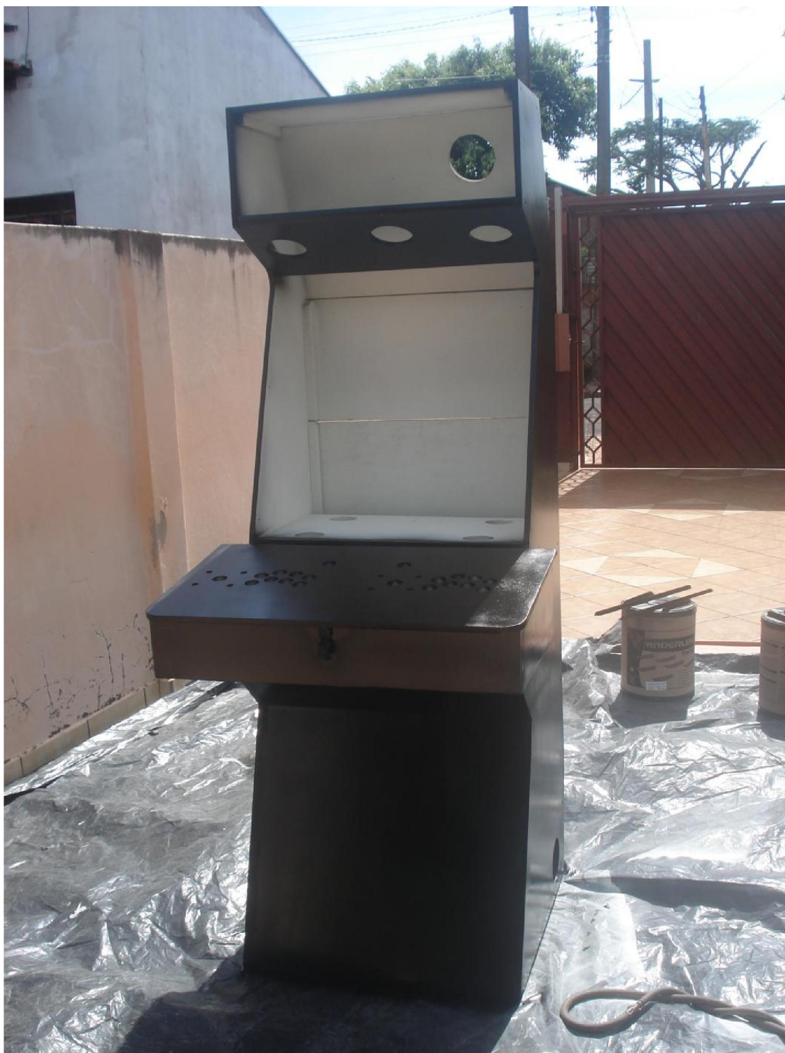
Figura 67 – Gabinete pintado com tinta preta, visível o furo de entrada de ar na lateral inferior e o de saída de ar na parte superior
