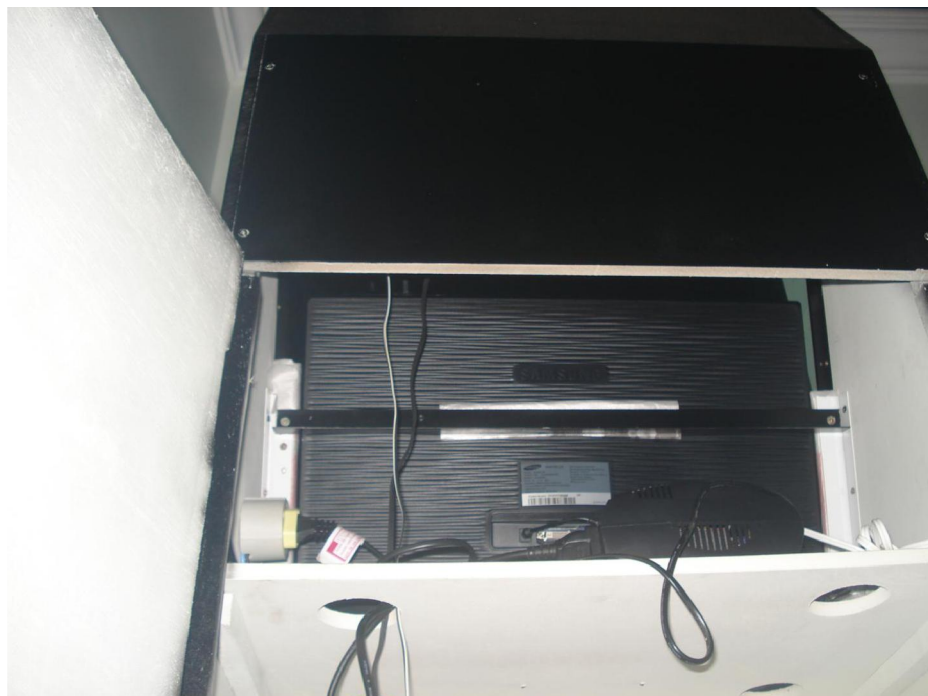
Figura 80 – Monitor fixado e preso a uma placa de ferro para não ficar vibrando junto com o gabinete
