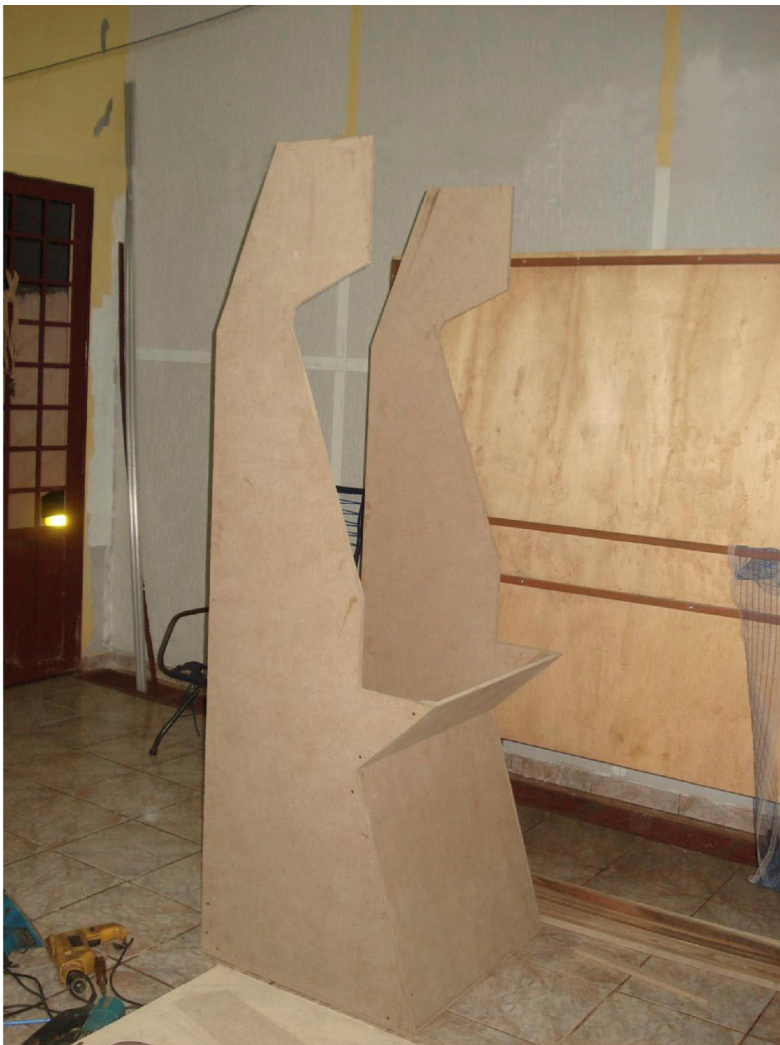
Figura 56 – Parte inferior dianteira e da base do controle prendendo as laterais do gabinete usando sarrafos e parafuso – Vista Dianteira
