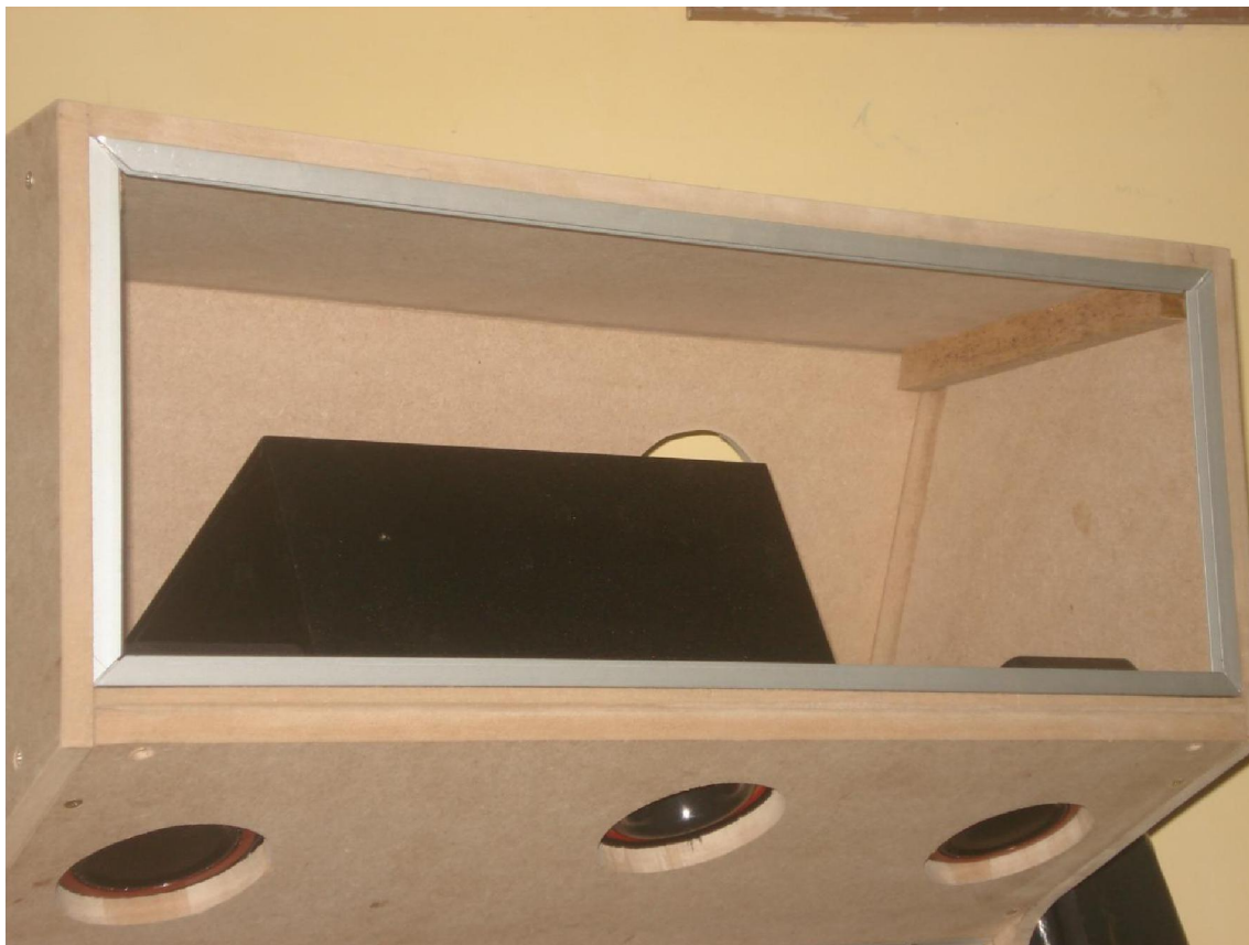
Figura 62 – Furos na parte inferior da marquee, caixa de som e cantoneiras para suporte do vidro da marquee
