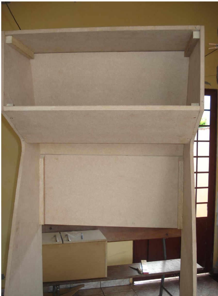
Figura 57 – Parte inferior e superior da marquee, presas as laterais com sarrafos e parafusos
