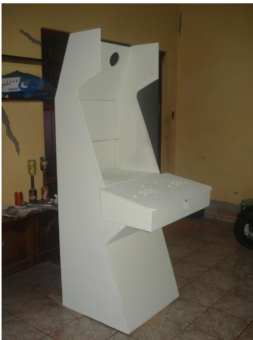
Figura 66 – Gabinete pintando com tinta base branca, visível o furo de saída de ar
