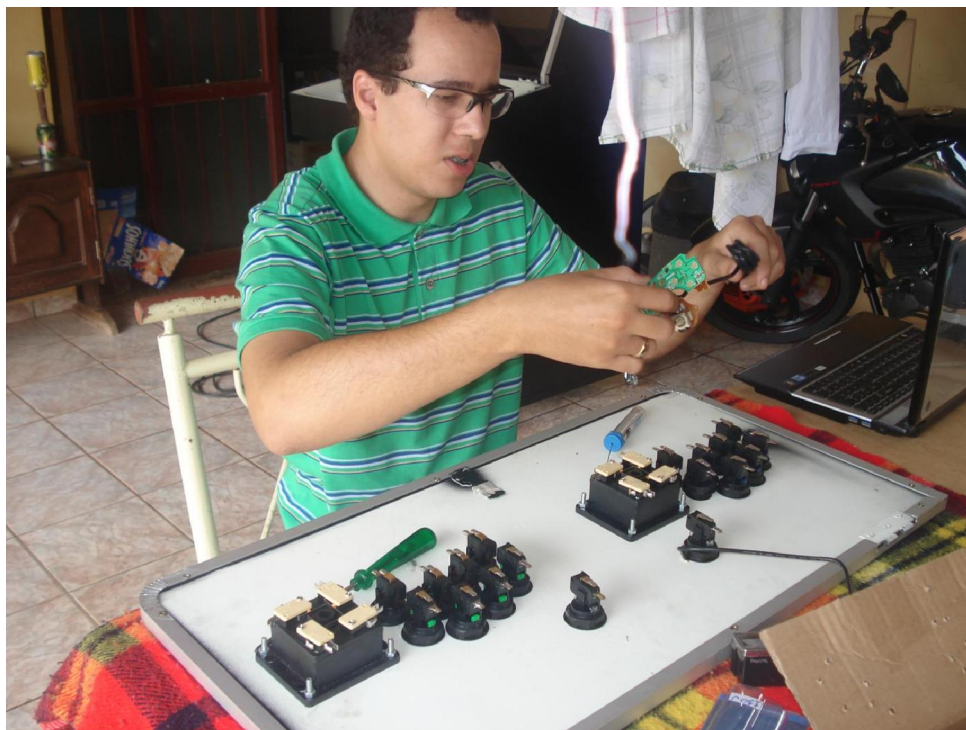
Figura 75 – Preparação para a solda da placa do controle USB no kit arcade
