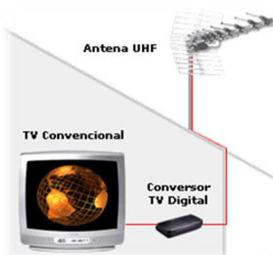
Figura 5: Conversor utilizado nos televisores analógicos
