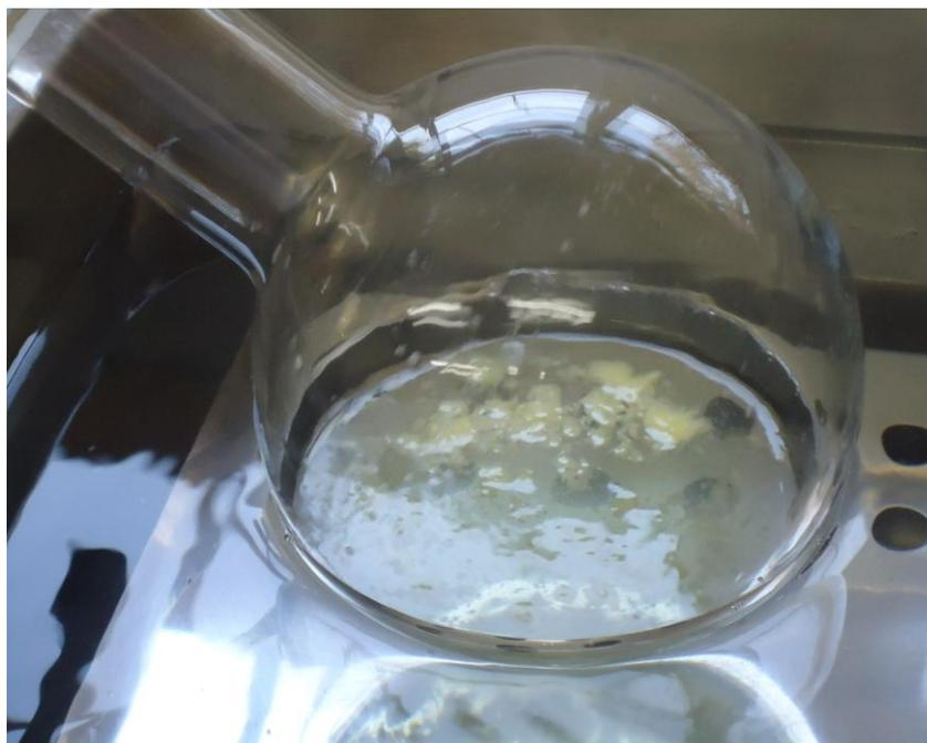
**Figura 12 – Mistura de 2 g de ricota triturada com 100 mL de NaOH 4,2 M em banho-maria.**
