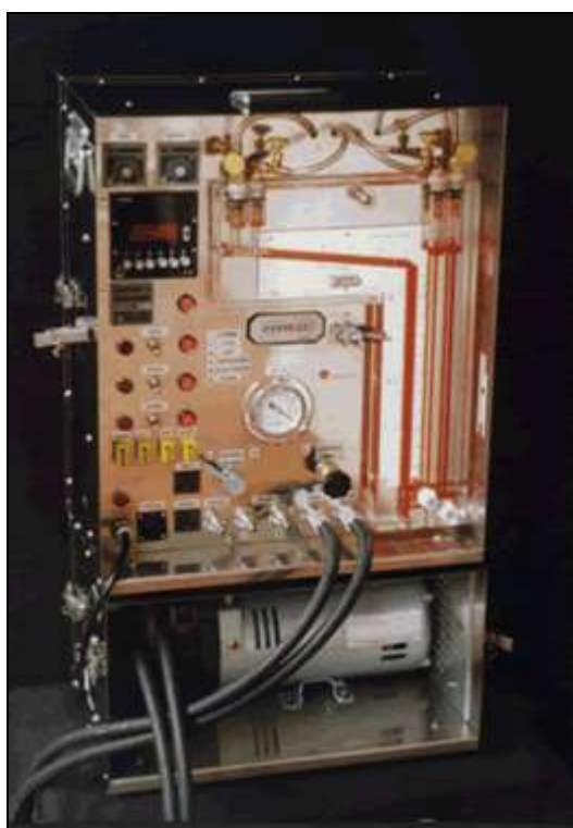
Figura 7 - Coletor Isocinético de Poluentes Atmosféricos.
