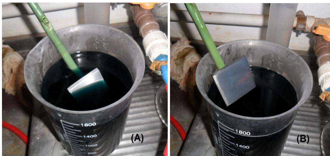
Figura 34 – Peça submersa em banho de zinco (A); Superfície do alumínio após a redução do zinco (B)
