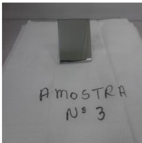
Figura 45 – Peça C não apresentou corrosão ao teste de névoa salina
