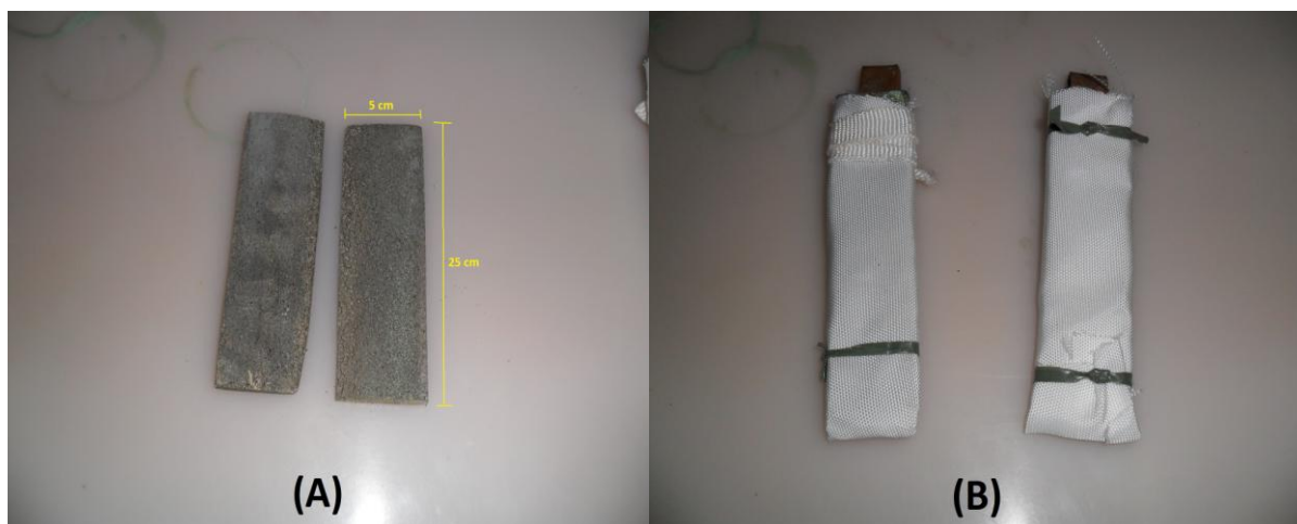
Figura 30 - Placas de anodo de níquel utilizadas para a eletrodeposição de níquel (A), Placas de anodo de níquel ensacadas com tecido de polipropileno (B)
