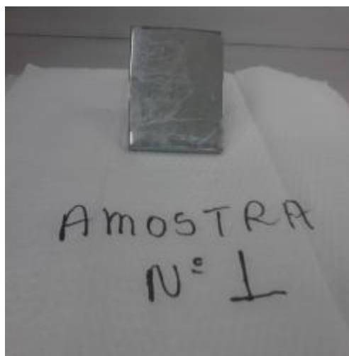
Figura 43 – Peça A com pontos de corrosão devido ao teste de névoa salina
