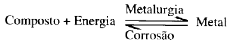
Figura 4 - Esquema representativo do processo de corrosão (In: Gentil, 1996, p. 5)
