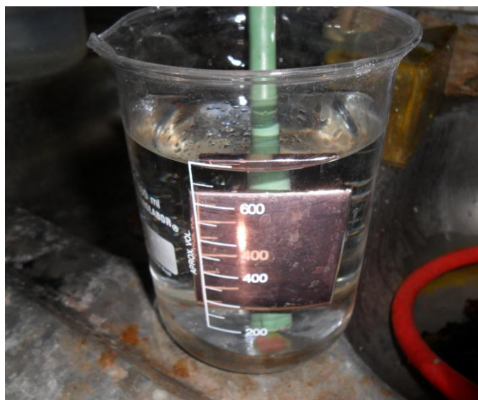
Figura 36 – Peça passando por ativação em ácido sulfúrico
