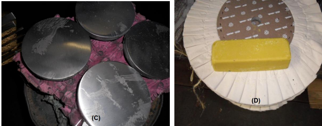
Figura 9 - Máquina de polimento semiautomático (A); Roda de sisal (B); Superfície polida (C); Barra de sebo utilizado para fixar a massa na roda (D)
