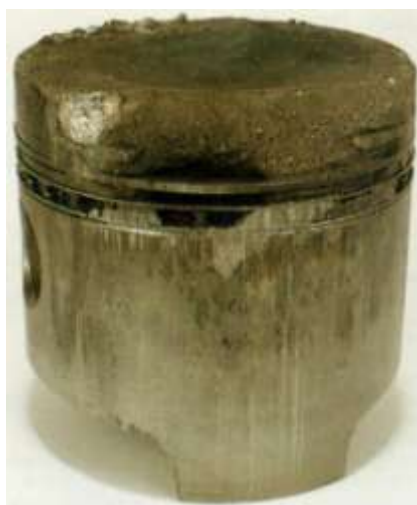
Figura 4 - Formação de depósitos no pistão (In: ANDRE, 21 de jul. 2010).
