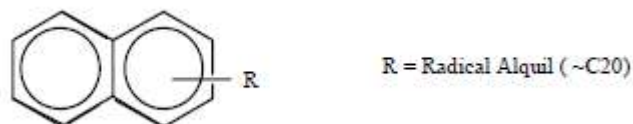
Figura 3 - Estrutura química do abaixador do ponto de fluidez: naftalenos alquilados( In: GUIMARÃES, 2006, p.28).
