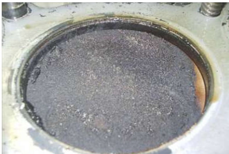
Figura 1 - Carbonização no cabeçote (In: TORNADEIROS, 21 de jul. 2010)
