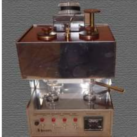
Figura 12 - Viscosímetro Saybolt (In: SOLOCAP GEOTECNOLOGIA, 21 de jul. 2010).
