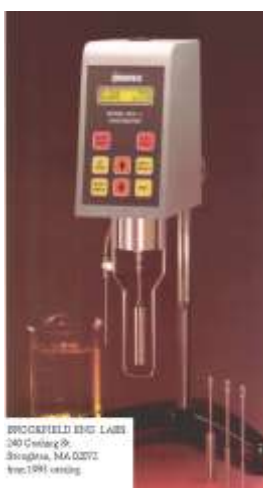
Figura 11 - Viscosímetro rotativo (In: MEDIÇÃO DE NIVEL, INTERFACE E VISCOSIDADE DE LIQUIDOS, 21 de jul. 2010).
