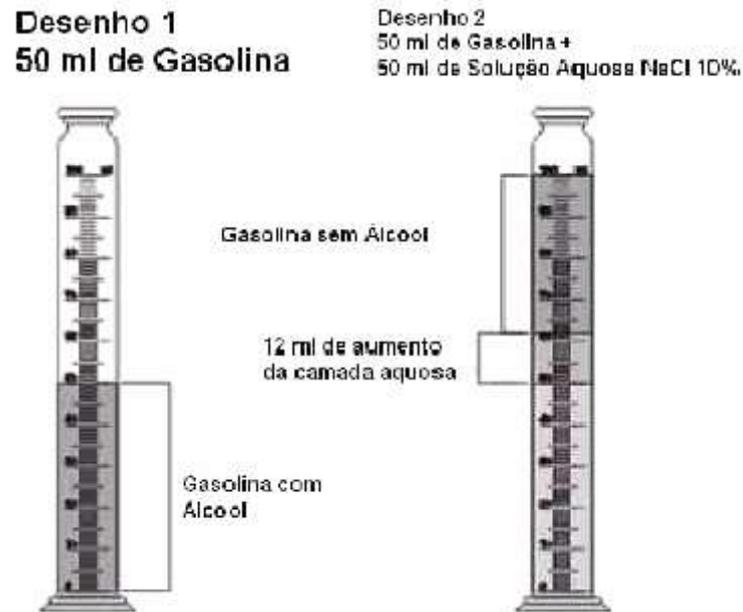
**FIGURA 4 - Ilustração do método utilizado na determinação das porcentagem de álcool na gasolina (In: LIMA, 2009).**
