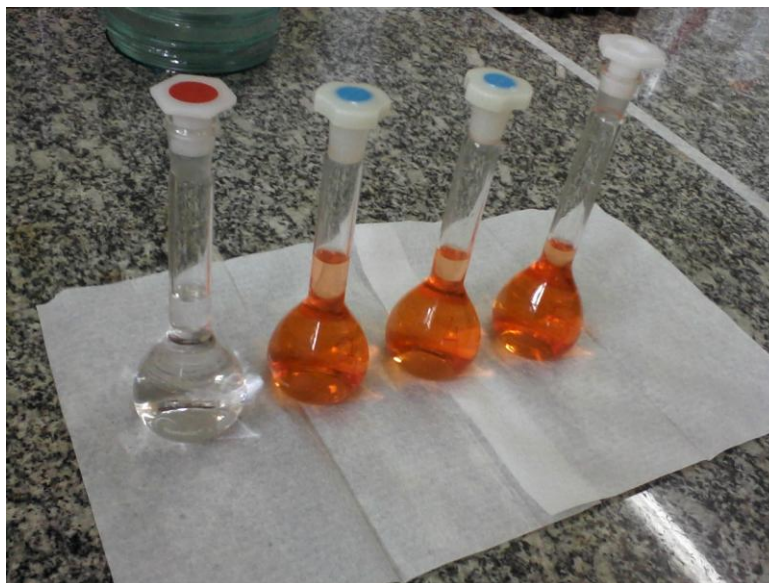
Figura 8 – Soluções das amostras de farinha de trigo para análise da concentração de ferro
