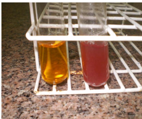
Figura 8: Identificação de ácido kójico através da complexação com cloreto de ferro III.
