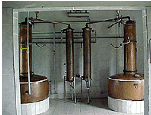
Figura 3 - Dois alambiques de cobre com capacidade de 400 litros cada (In: OLIVEIRA, 2007, p. 7).
