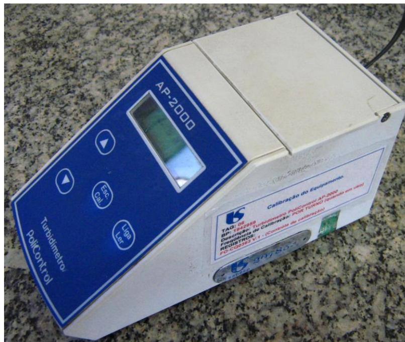
**Figura 5 – Turbidímetro usado nos ensaios.**
