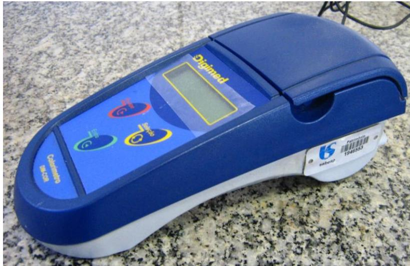
**Figura 6 – Equipamento usado nas análises de cor.**
