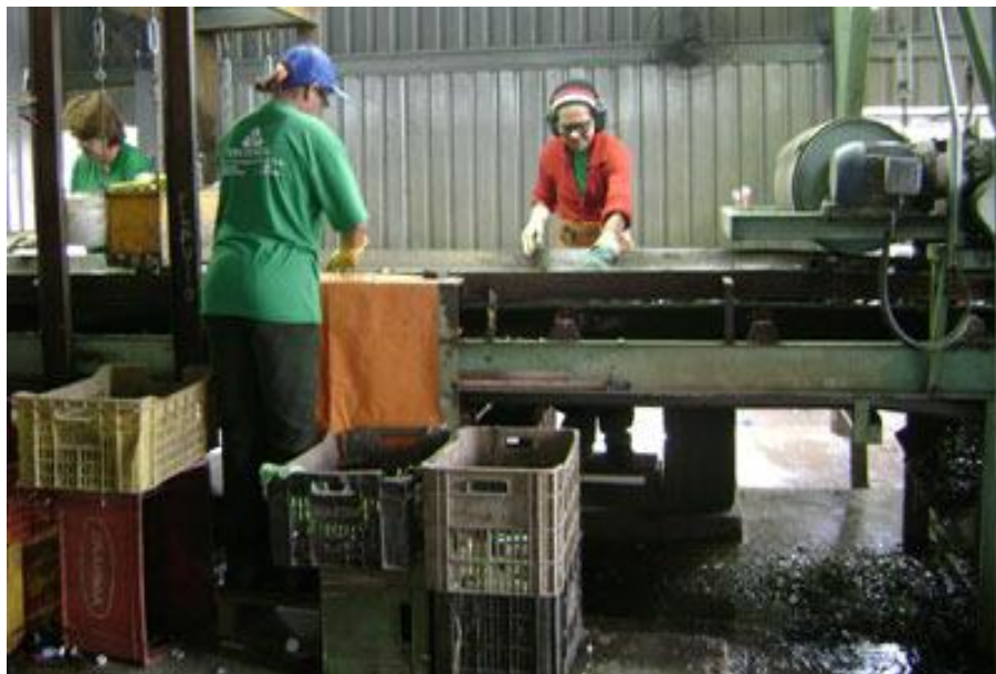
Figura 14 – Processo no qual os catadores retiram as etiquetas do vidro já quebrado (Indriunas, 2011).
