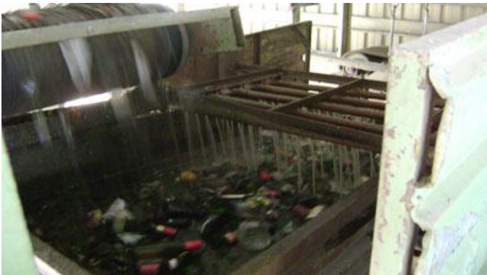
Figura 13- Os vidros passado pelo processo de lavagem (Indriunas, 2011).
