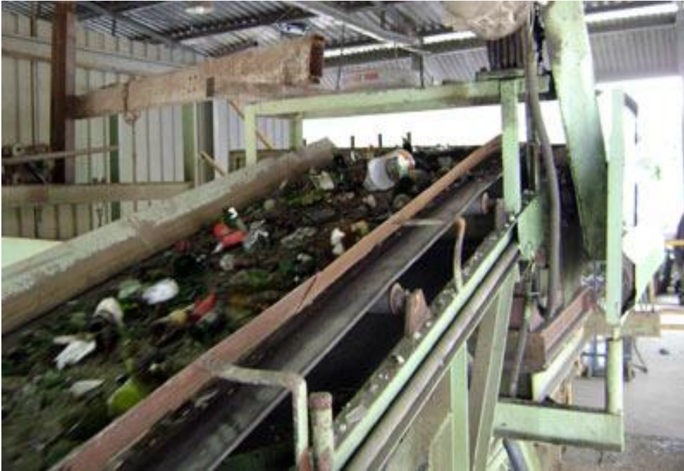
Figura 12- Vidro passando pela esteira para detectar impurezas (Indriunas, 2011).
