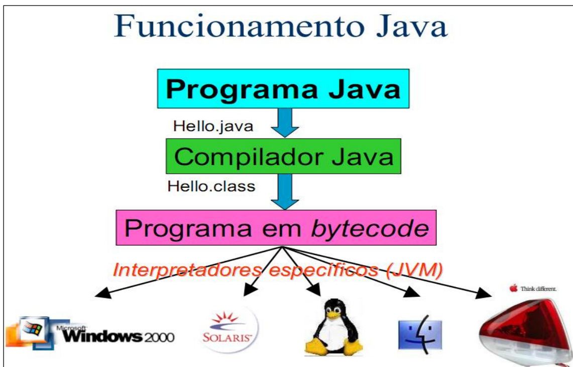
Figura 7: Funcionamento da JVM.
