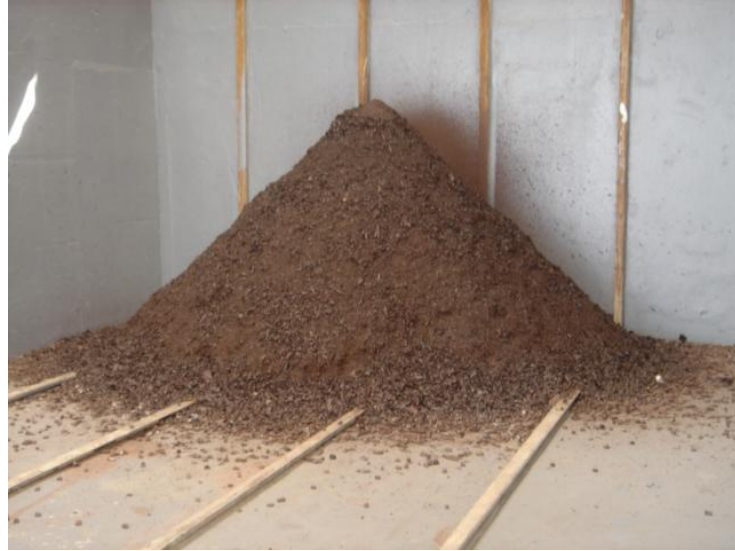
Figura 7: Pastelo (material interno) que será reduzido a chumbo metálico
