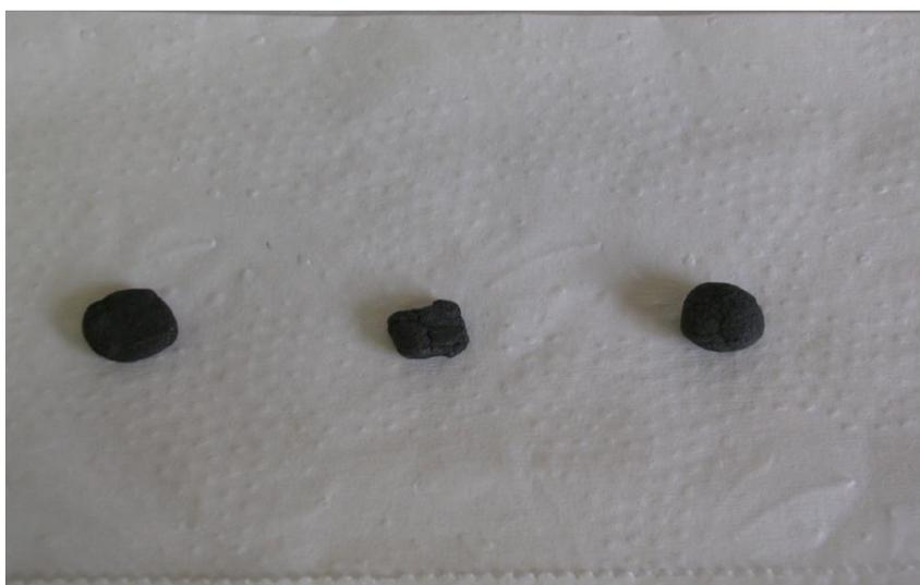
**Figura 26 – Chumbo livre obtido a partir do óxido.**
