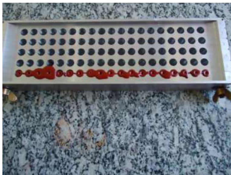
Figura 16 - Envasamento dos batons
