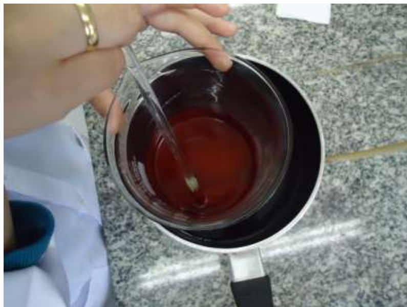
Figura 15 - Adição de óleo de rícino e pigmento
