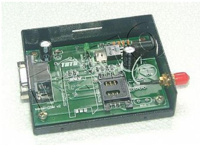
Figura 7b – Modem GSM vista Interna- SIM304
