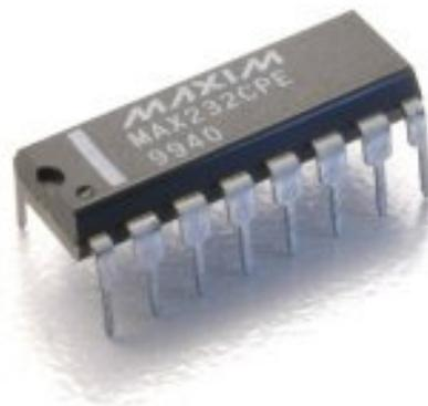
**Figura 12 – Circuito integrado MAX 232**
