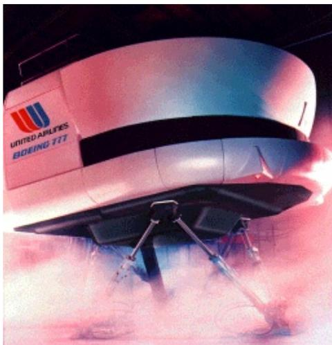
**Figura 6 - O simulador de vôo da Boeing 777 considerado a mais sofisticada aplicação de RV. (Hosn e Costa, 1999)**
