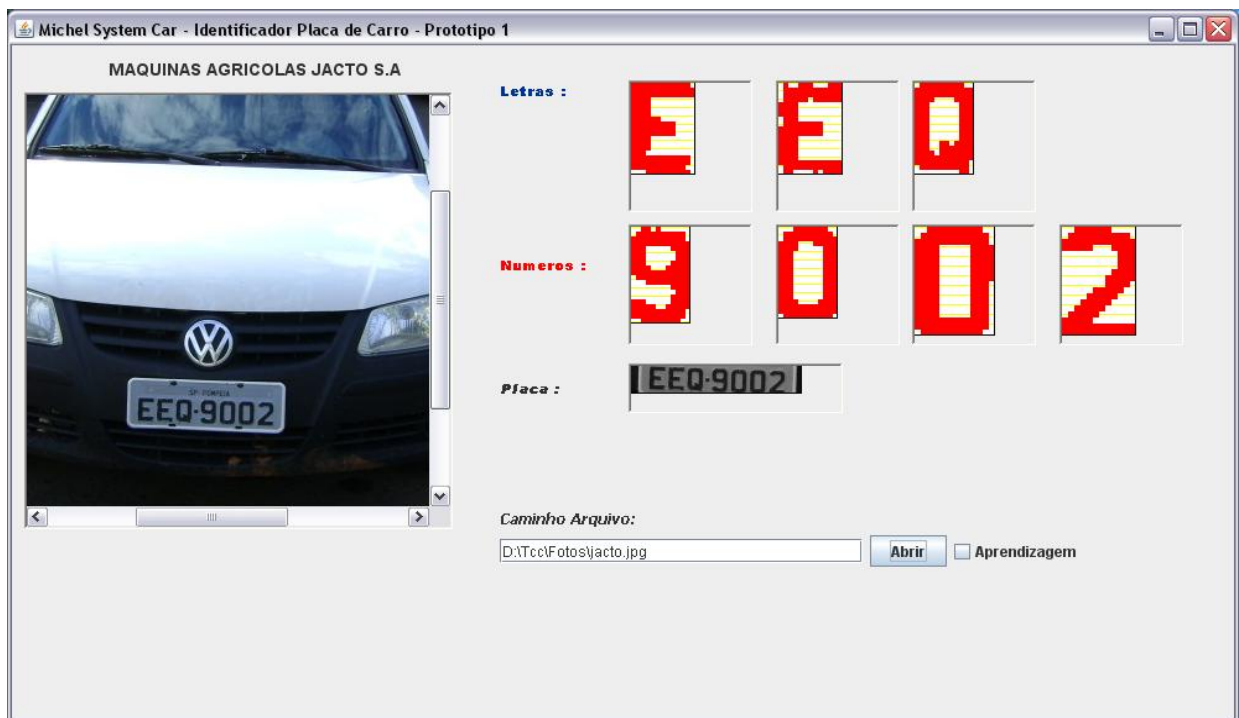
Figura 4.12. Execução do sistema proposto
