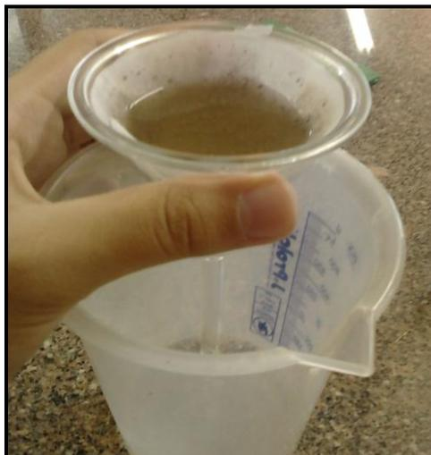
**Figura 39: Filtração da mistura para o recolhimento do hidróxido de prata**
