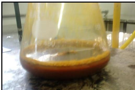
**Figura 51: Flúido formado ao fim da adição de hidróxido de amônio, com as mesmas características do produzido anteriormente pelo mesmo método, demonstrando que o líquido formado não se trata de um ferroflúido.**
