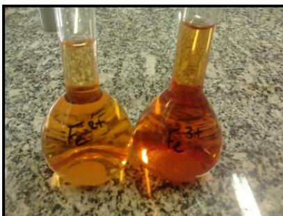
**Figura 52: Soluções aguardando leitura no espectrofotômetro**
