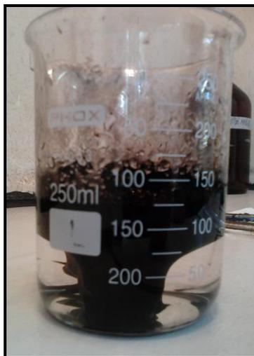
**Figura 18: Separação das fases aquosa e orgânica**
