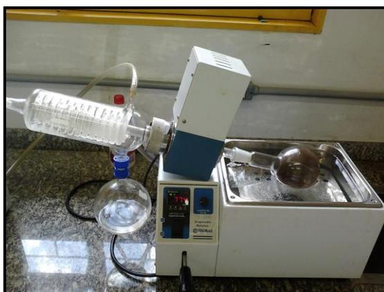
**Figura 44: Solução contendo o hidróxido de tetrametilamônio em evaporador rotativo para completa secagem**
