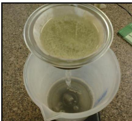
**Figura 43: Filtragem da mistura para o recolhimento do precipitado separando-o da solução que continha o hidróxido de tetrametilamônio diluído.**
