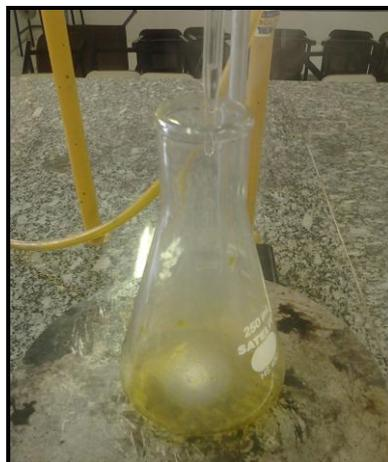
**Figura 50: Adição de  $\text{Fe}^{2+}$  e  $\text{Fe}^{3+}$  em um erlenmeyer e, com auxílio de bureta, adição de  $\text{NH}_4\text{OH}$**
