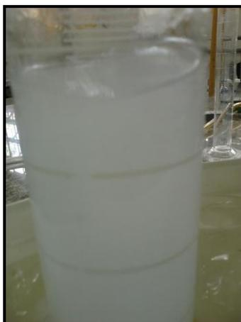
**Figura 34: Proveta após a adição de iodeto de metila. A coloração esbranquiçada e turva indica a produção da amina terciária através da reação.**
