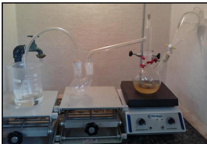
**Figura 15: Sistema montado para a obtenção da trimetilamina no HCl**
