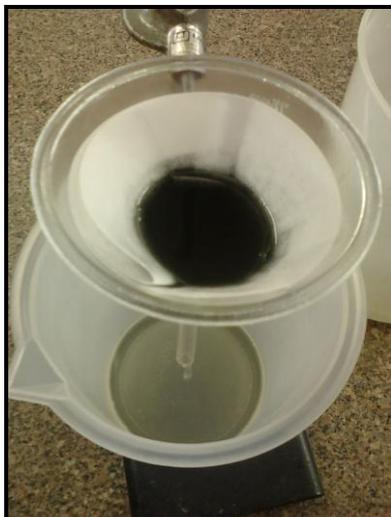
**Figura 45: Filtração para retirada de resíduos de prata**
