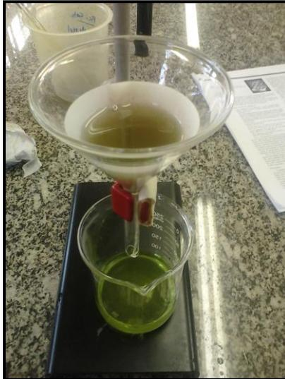
**Figura 48: Filtração da solução para retirada de partículas**
