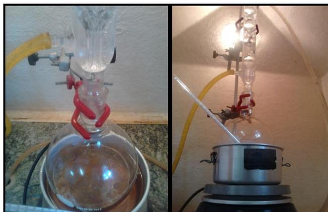
**Figura 13 e 14: Mistura reacional em banho de óleo acoplada a um condensador de refluxo**
