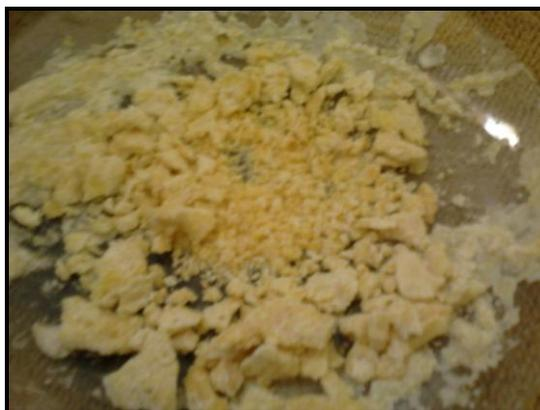
**Figura 38: N(CH<sub>3</sub>)<sub>4</sub>I após secagem**
