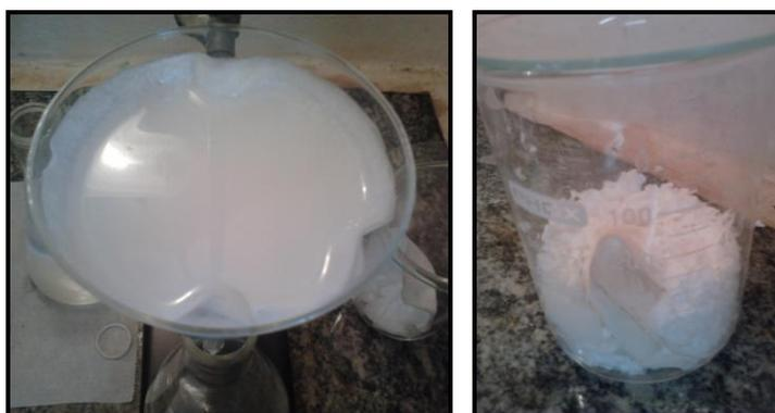
**Figura 11 (esquerda): Filtração do formaldeído**
