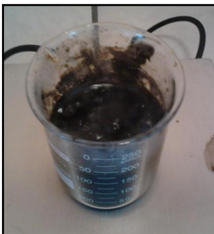
**Figura 17: Mistura após a adição de  $NH_4OH$**
