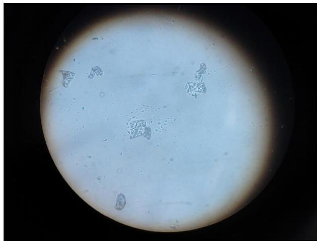
**Figura 21: Visão microscópica do fluído formado, comprovando a aglomeração de suas partículas, descartando o método do projeto.**
