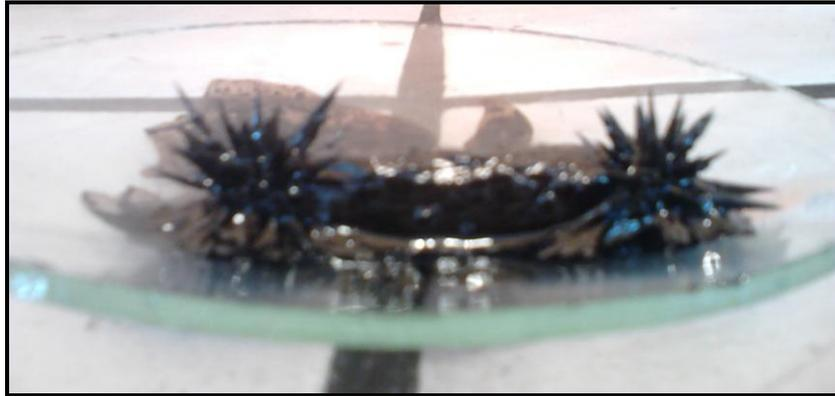
**Figura 20: Visão macroscópica do fluído formado através do método da patente sobre um bastão magnético, demonstrando corresponder ao campo magnético.**
