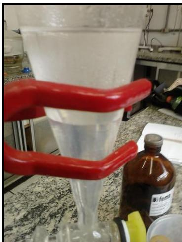
**Figura 32: Agitação do produto com bissulfito de sódio**
