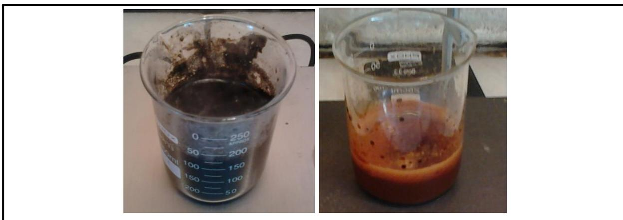
**Figura 27: Diferença entre os fluídos magnéticos obtidos pelo método da patente (esquerda) e o método de BERGER (direita)**
