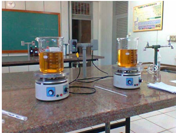
Figura 3- Transesterificação do óleo
